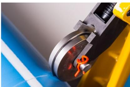
Wenn **Rohre abgelängt** werden, muss der Schutzmantel – entsprechend dem voreingeschnittenen Rohr dieses Durchmessers – mit dem passenden Rohrschneidergerät ROB-RS... eingeschnitten werden. Danach verfahren Sie wie zuvor beschrieben.
