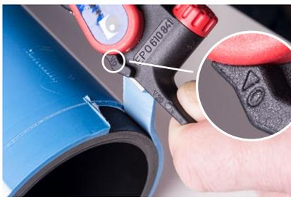
Drücken Sie die Klinge hinein, um einen Einschnitt zu machen und führen Sie einen Schnitt so lange, bis die Markierung (siehe Detail) am Werkzeug den Schnitt im Mantel erreicht. Danach ziehen Sie mit der Klinge des **ROB-SCHÄLER/V** den Schutzmantel zügig ab.
